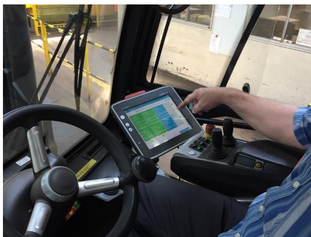
Abb. 3: Die mit Online-Schnittstellen versehene Software steht unter anderem für Transparenz hinsichtlich offener Stapleraufträge
